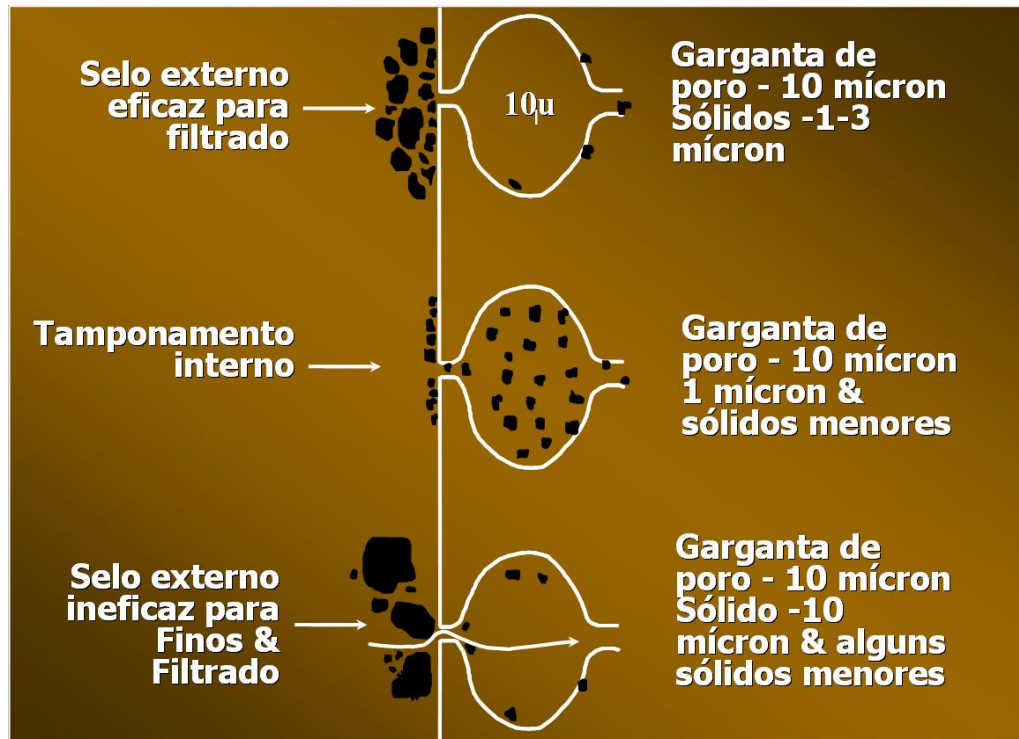
Figura 9 - Danos causados por filtrado do reboco e sólidos da lama.
